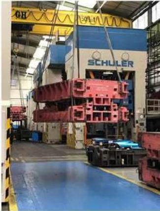
Las cargas suspendidas colapsan la circulación impidiendo el paso de personas y vehículos.
